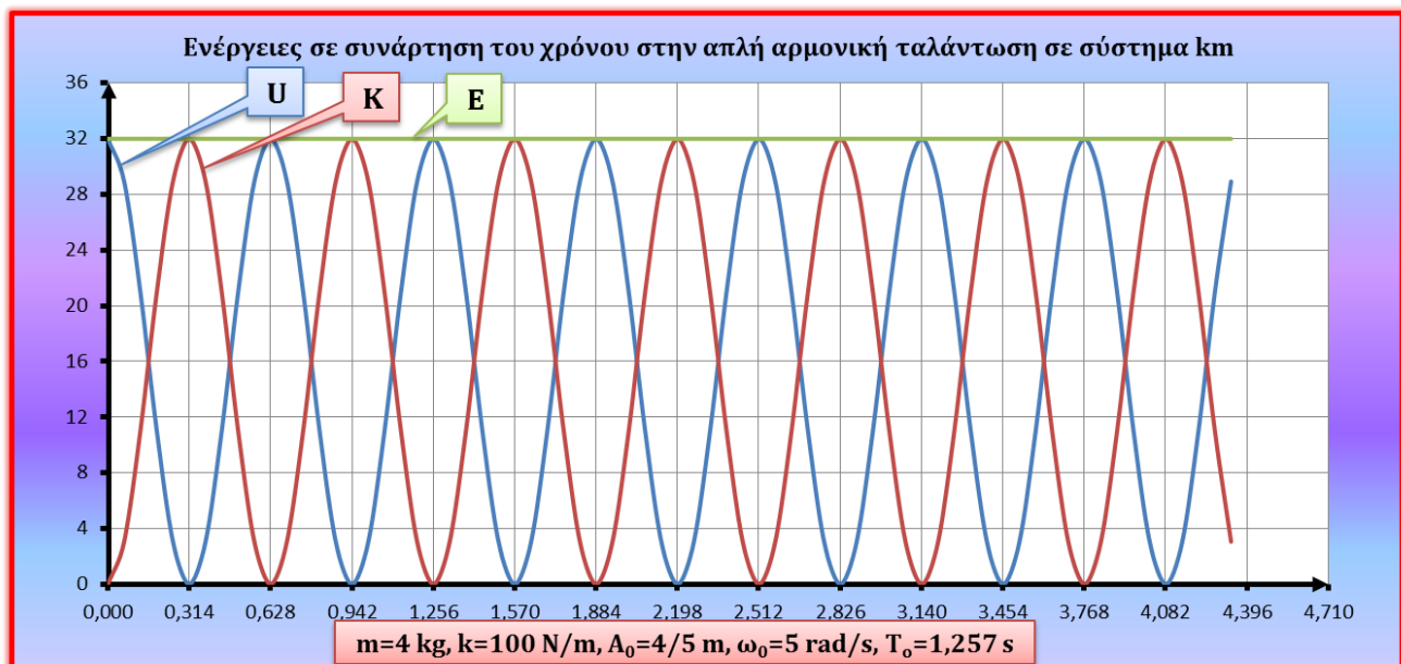
Σχήμα 12: Οι ενέργειες σε συνάρτηση του χρόνου της απλής αρμονικής ταλάντωσης του παραδείγματος
